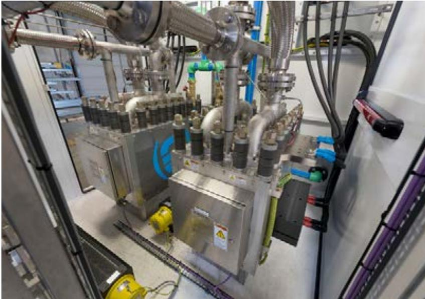
**Figura 30.** Electroizador PEM de 1,2 MW del proyecto HyBalance, Dinamarca<sup>43</sup>.
